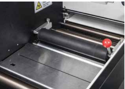
Plataforma para empalmes
